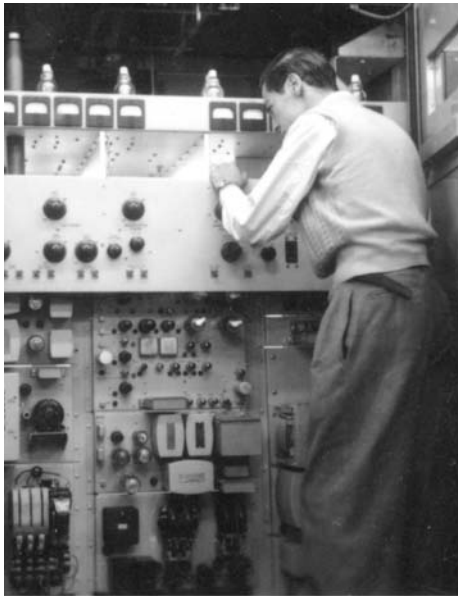
1953 Transmissor da TV Tupi no Pão de Assucar. GE de 5 kW . O modulador e excitador.
